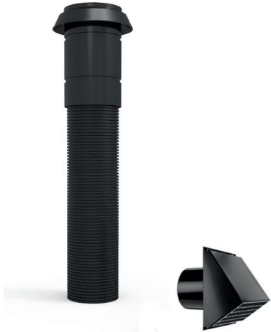
De Isocomplus+ geïsoleerde kanalen zijn beschikbaar in 3 diameters: binnendiameter Ø 125 mm met buitendiameter Ø 160 mm, binnendiameter Ø 174 mm met buitendiameter Ø 200 mm en binnendiameter Ø 200 mm met buitendiameter Ø 250 mm.
